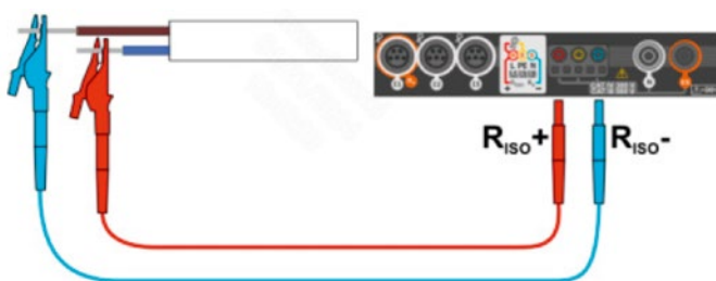
Rys. 2. Punkty pomiaru rezystancji izolacji [3]
